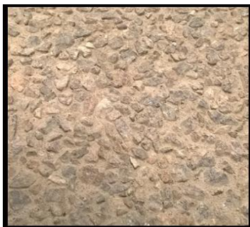
GWB 8 3 frakcje kruszywa. Próby w toku Tekstura – szczotka stalowa „ręczna”
