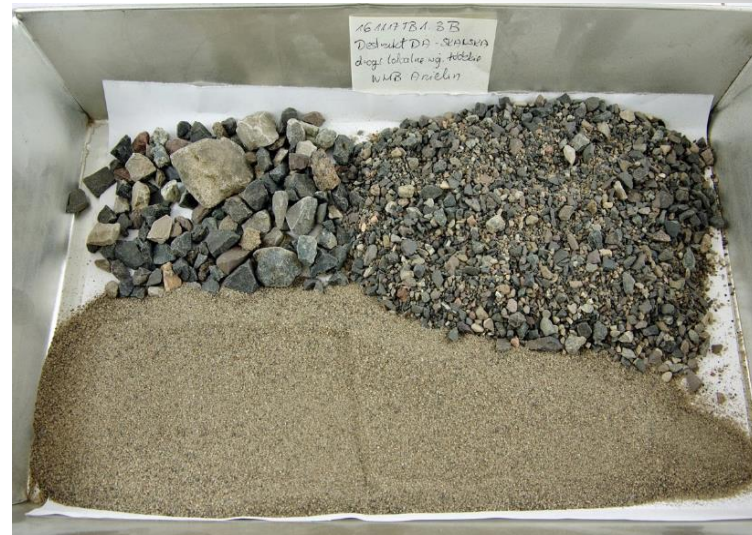
Fotografia 1 Przykładowy destrukcyjny materiał pochodzący z frezowania warstwy asfaltowej
