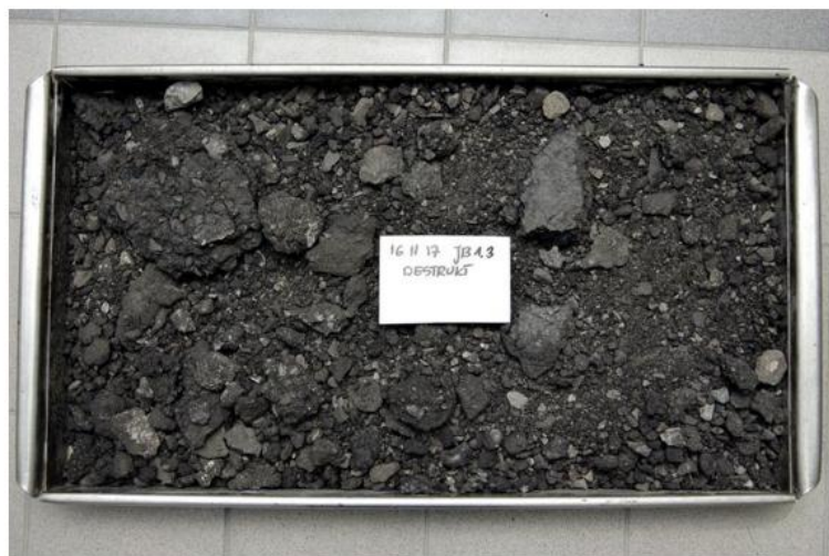
Fotografia 1 Przykładowy destrukcyjny materiał pochodzący z frezowania warstwy asfaltowej
