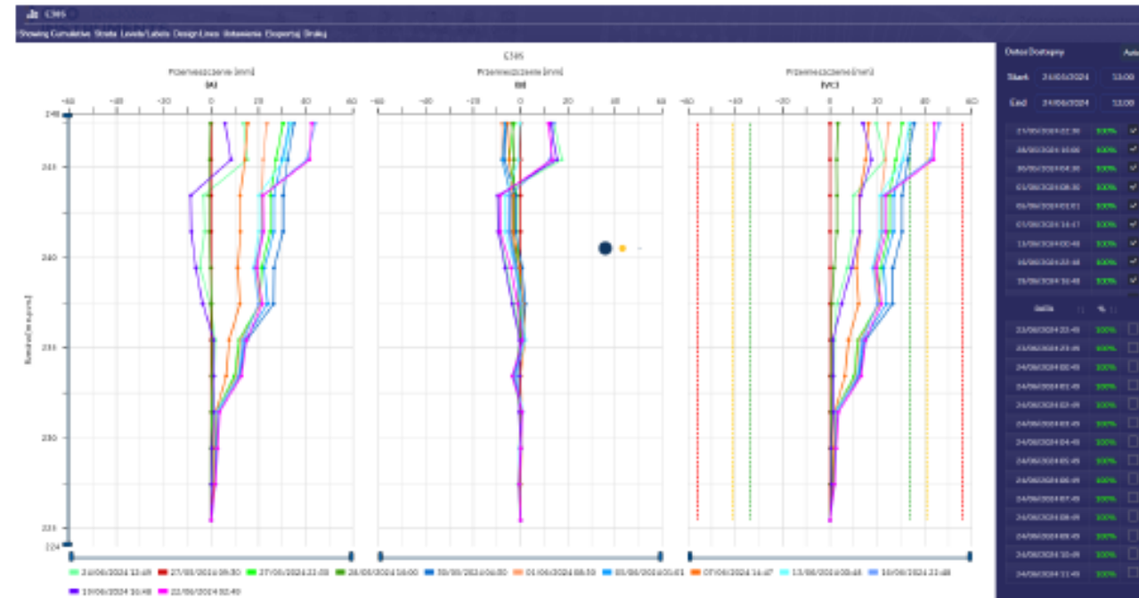
Rysunek 4. Przemieszczenia inklinometru E.38
