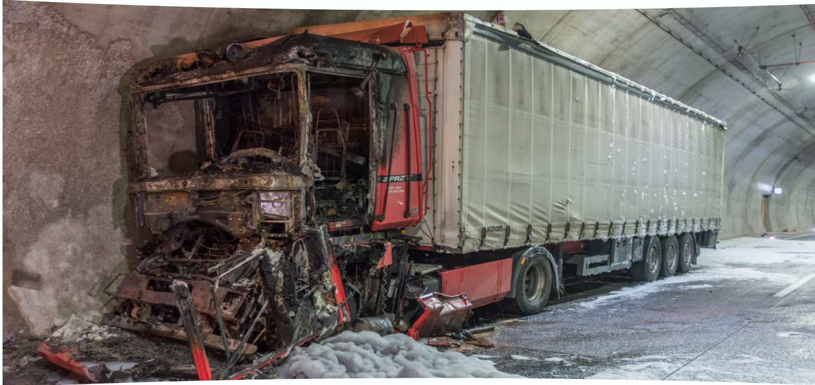
Widok samochodu ciężarowego po zdarzeniu pożarowym
