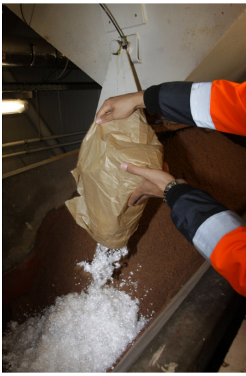
Zugabe im Zwangsmischer, Zugabemenge 2\text{kg/m}^3 Beton
