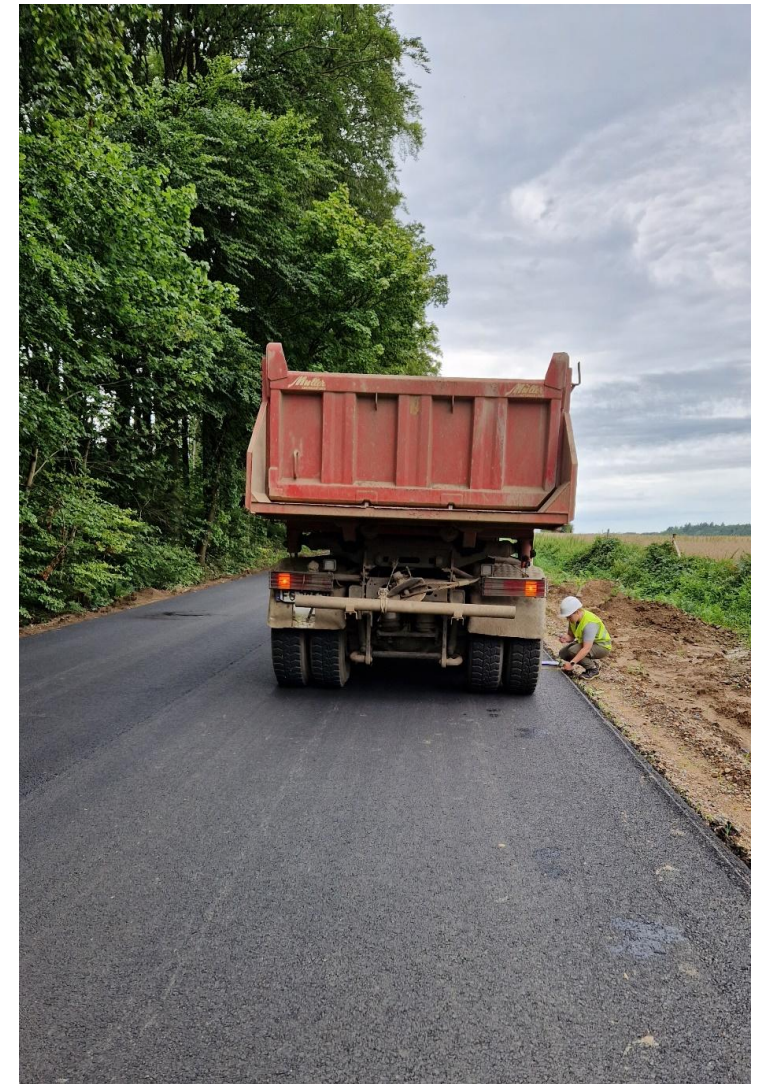
Obciążenia statyczne oraz dynamiczne (przejazd samochodu)
