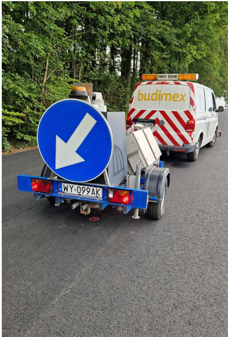
Badanie nośności z użyciem ugięciomierza dynamicznego FWD (obciążenia dynamiczne)
