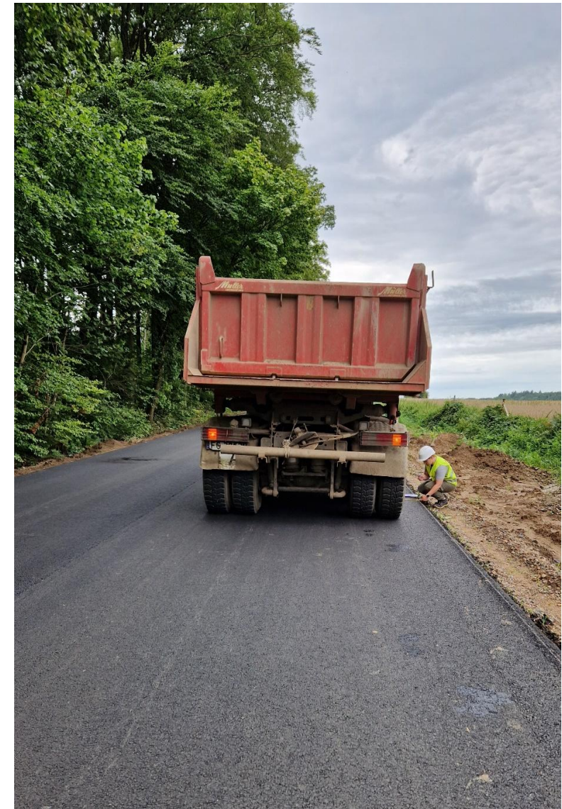
Obciążenia statyczne oraz dynamiczne (przejazd samochodu)
