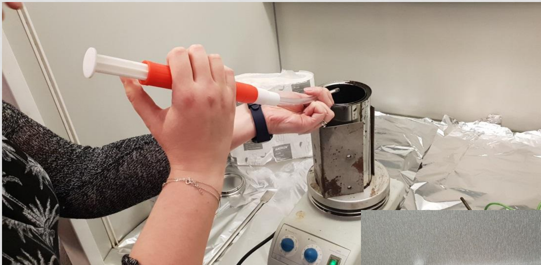
Pobieranie próbki fazy gazowej znad asfaltu
