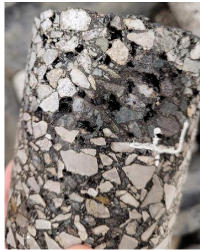
Brak właściwej szczepności, zagęszczenia i grubości na inwestycji A1 odcinek – dojazd do obiektów
