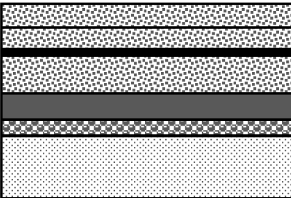
Typ IIB - nawierzchnia betonowa dwuwarstwowa układana „mokre na mokre” o ciągłym zbrojeniu
