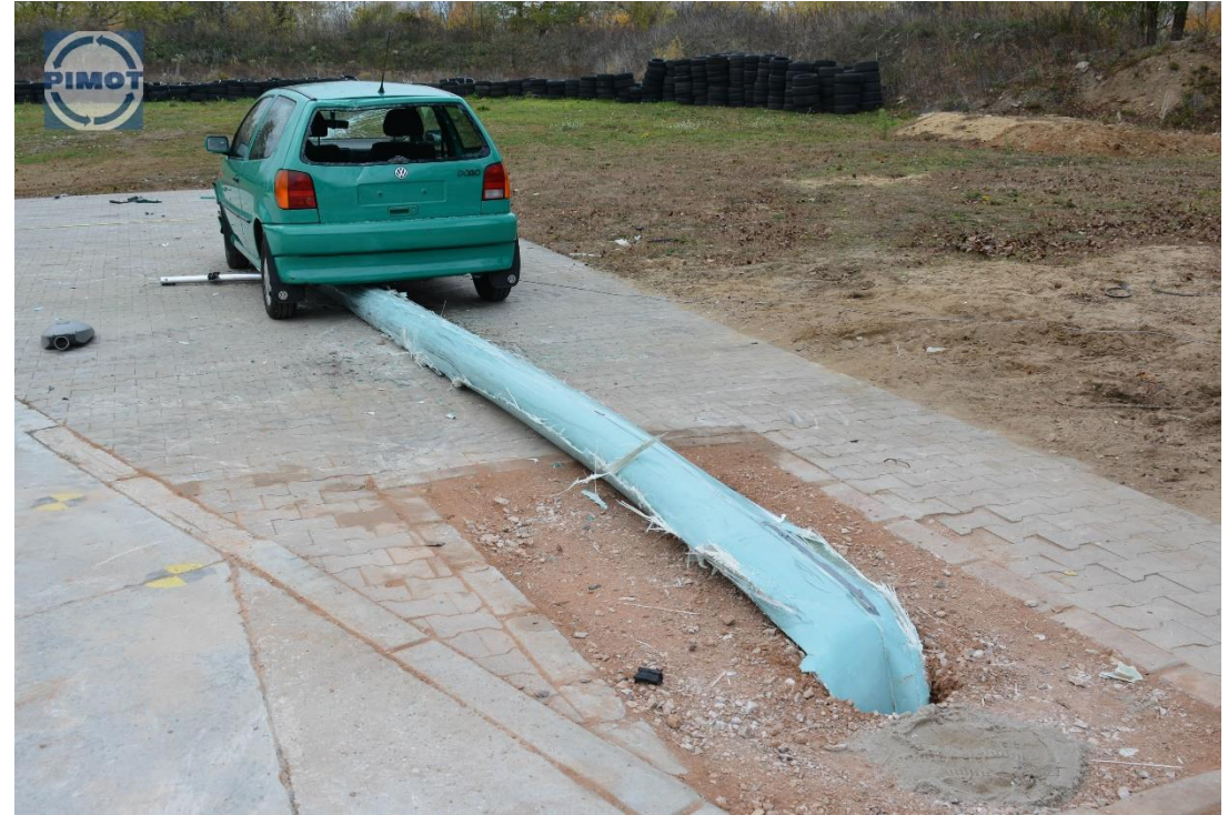
W wyniku testu uzyskano konstrukcję w klasie 50,HE,3
