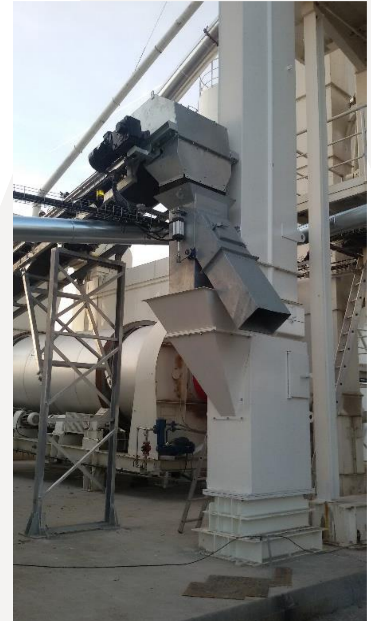
Kłapa przestawna do łatwego opróżniania dozatorów recyklingu
