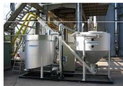
2. Automatyczne dozatory wprowadzające środki WMA do linii asfaltu bądź mieszalnika wytwórni mieszanek
