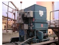
2. Automatyczne dozatory wprowadzające środki WMA do linii asfaltu bądź mieszalnika wytwórni mieszanek
