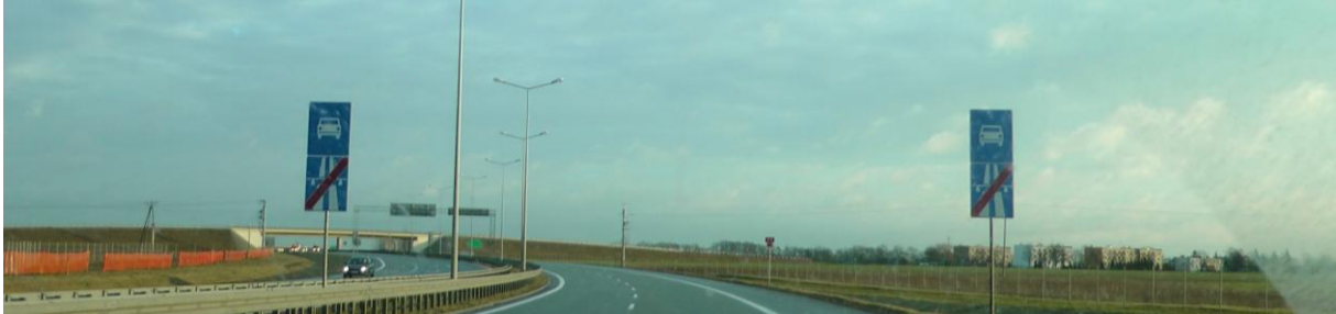
Zdj. 1 – droga jest albo autostradą, albo ekspresową, stąd znak D-7 „droga ekspresowa” automatycznie informuje kierowcę, że inna klasa drogi (tu: autostrada) się skończyła. Znak D-10 „koniec autostrady” jest więc niepotrzebny.
