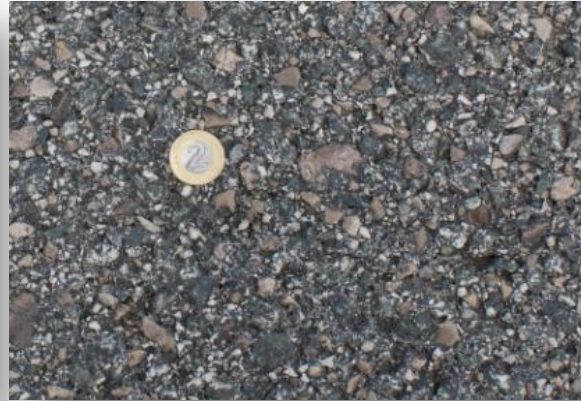
Kruszywo bazaltowe i dolomitowe
