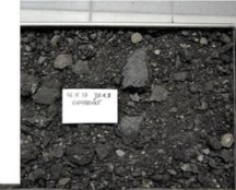
Fotografia 1 Przykładowy destruk pochodzący z frezowania warstwy asfaltowej
