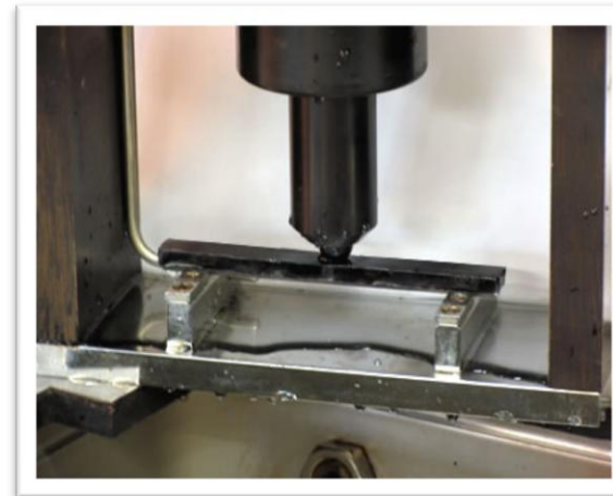
Widok próbki w aparacie BBR przed rozpoczęciem badania
