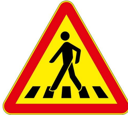
Znak A-16 przejście dla pieszych
