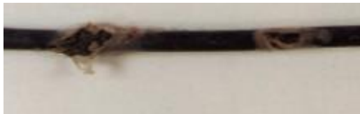
Korozja i pęknięcia przewodów i linek
