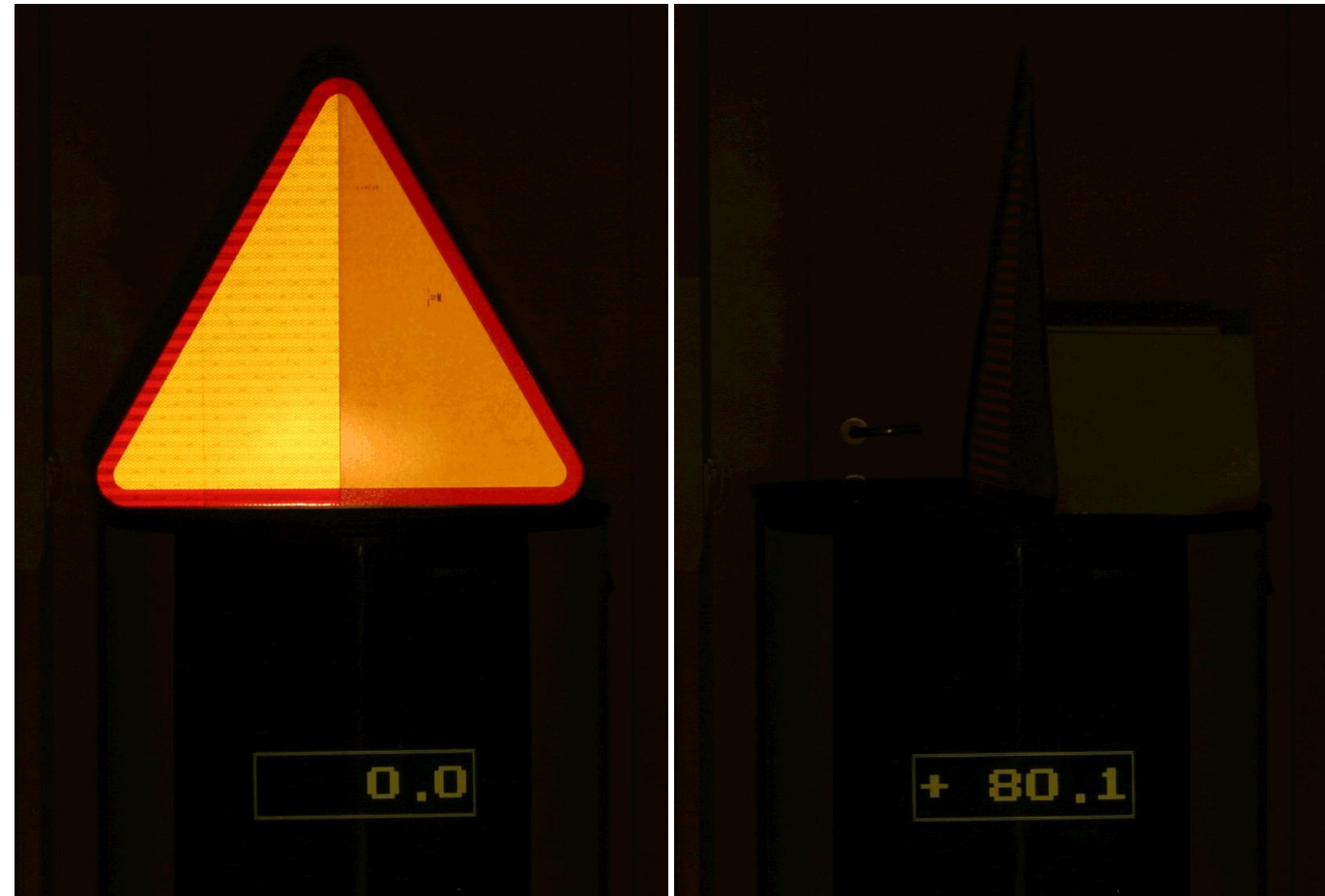
Znak ostrzegawczy wykonany z folii I typu, w technologii mikropryzmatycznej i mikrokulkowej
