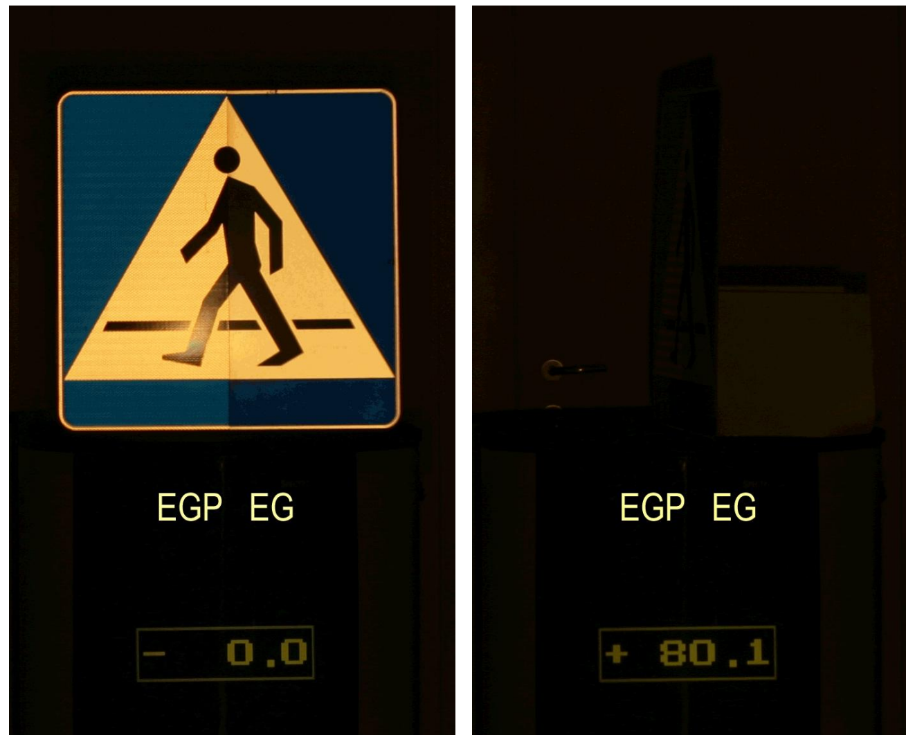
Znak D-6 wykonany z folii I typu, w technologii mikropryzmatycznej i mikrokulkowej
