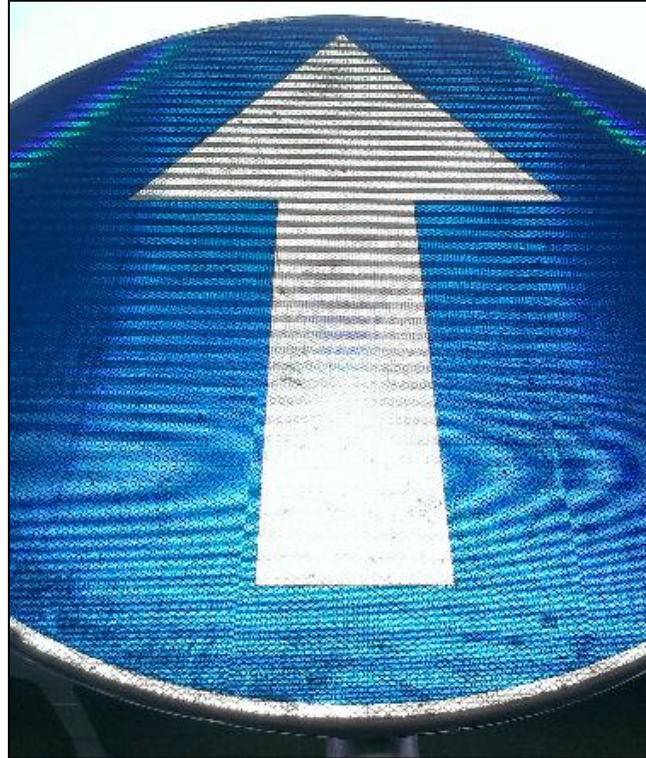
Znak C-5 wykonany z mikropryzmatycznej folii odbłaskowej I typu
