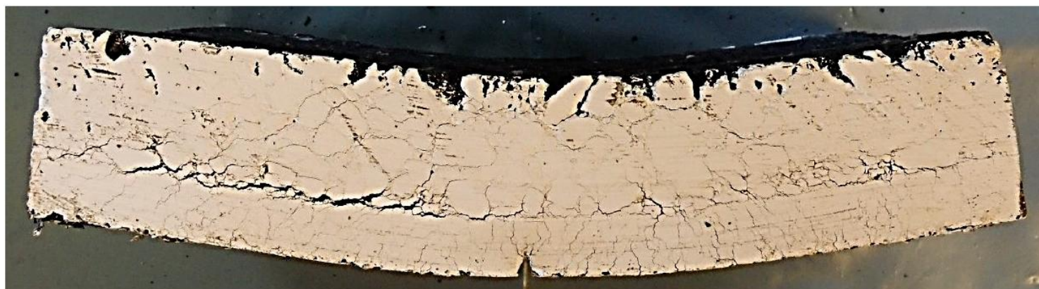
Próbka zbrojona kompozytem AR-GN po 155,000 obciążeń (współczynnik zwiększający > 3.7)
