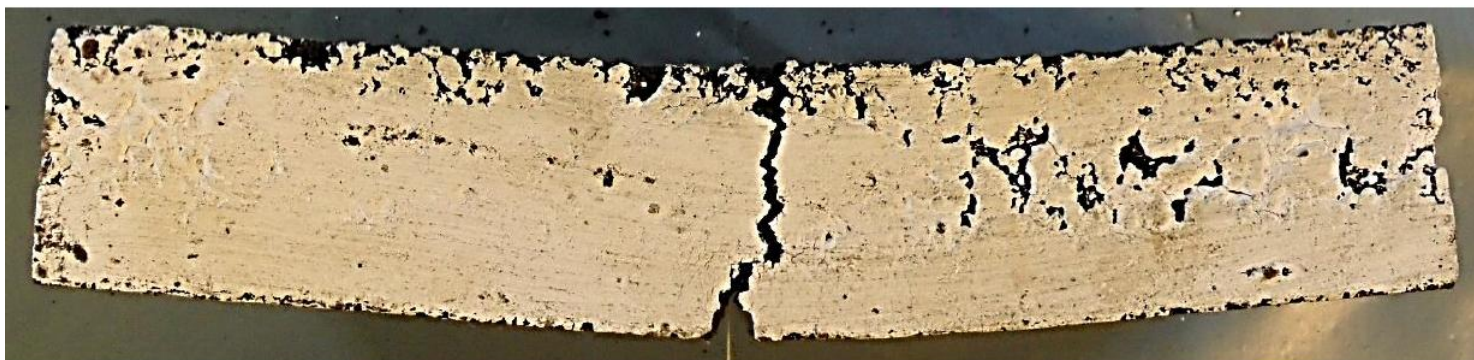
Próbka bez zbrojenia po 41,000 obciążeń
