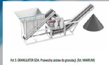
Fot. 3. GRANULATOR GDA. Przewoźny zestaw do granulacji. (fot. MAKRUM)
