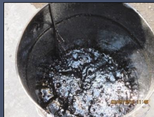
Fot. 4. Pomiar i ocena parametrów piany asfaltowej pobranej z kontrolnej dyszy recyklera
