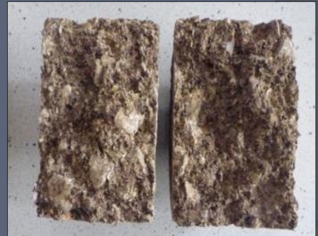
Fot. 3. Mieszanka wykonana metodą „na zimno” (przełom).
