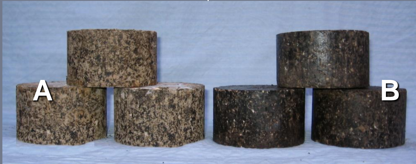
A – podbudowa z asfaltem spienionym
