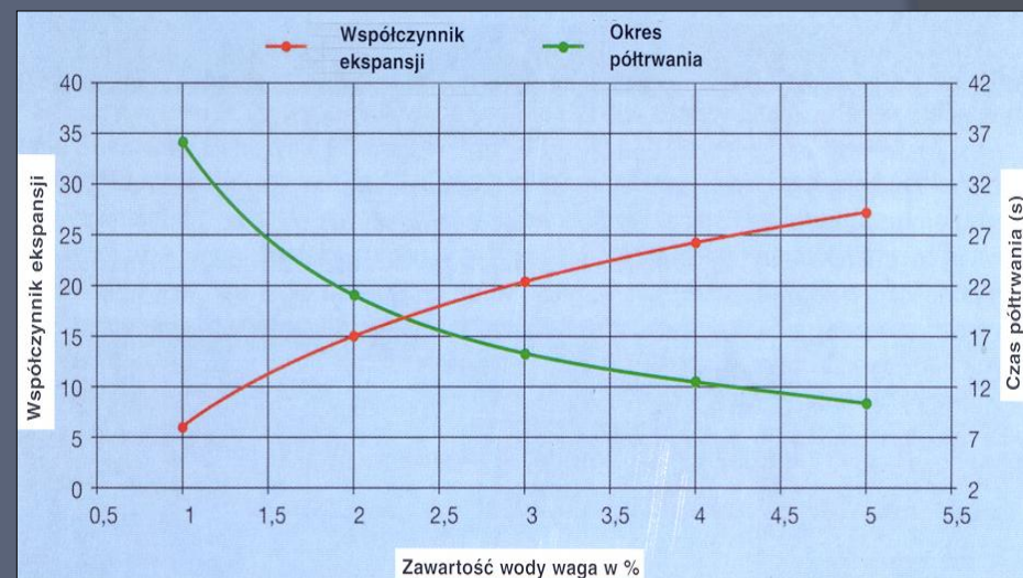
Rys. 8. Zależność ekspansji asfaltu i okresu półtrwania piany od ilości wody spieniającej [5]
