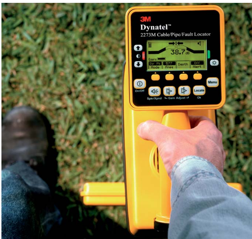
Rys. 1. Lokalizatory Dynatel służą do trasowania kabli i rur, wykrywania uszkodzeń powłok kabli, pomiarów głębokości, wykrywania sond, lokalizacji zakopanych znaczników elektronicznych EMS, odczytu i zapisu danych w markerach EMS-iD oraz tworzenia map cyfrowych w systemach GIS
