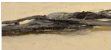
Uszkodzenia od wyładowań atmosferycznych
