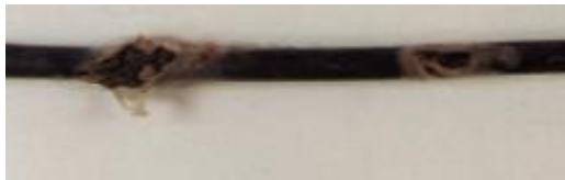
Korozja i pęknięcia przewodów i linek
